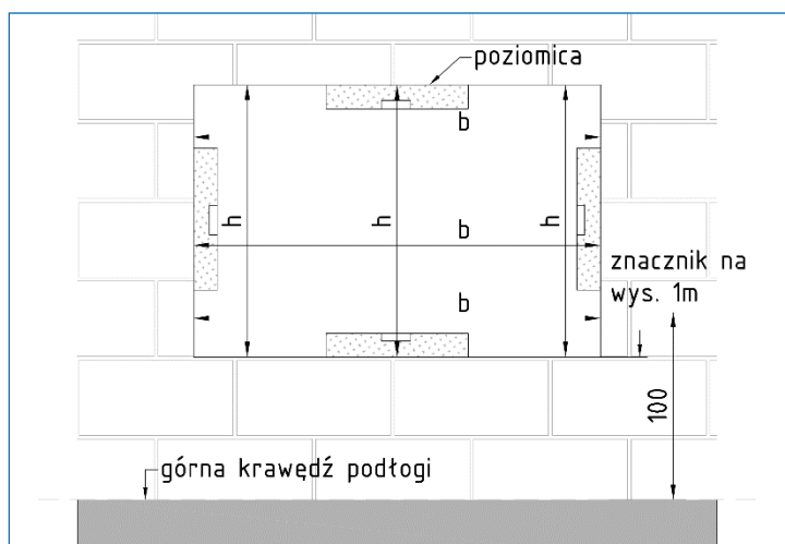
Obr. 2 Způsob měření okenního otvoru
