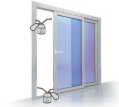
Alle Aspekte der Sicherheit der Beschläge, insbesondere der Befestigung (Schlösser, Schloss-, Riegel-, Haken- und Türgriffsperrern) sollten regelmäßig überprüft werden. Alle Nachstellarbeiten an den Beschlägen, insbesondere an Haken und Wagen, der Austausch von Teilen sowie die Flügelmontage und -demontage sollten von einem Fachmann durchgeführt werden.
