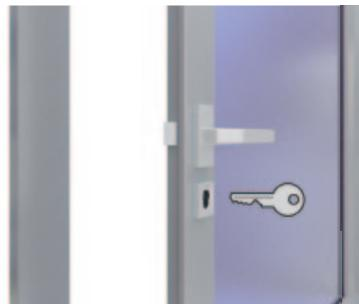
Wenn sich die Tür in der geschlossenen Position befindet, den Schlüssel zwei volle Umdrehungen drehen, um die Tür zu verriegeln und zu sichern. Um die Tür zu öffnen, den Schlüssel zwei volle Umdrehungen nach links drehen und den Griff drücken, um die Tür zu öffnen.
