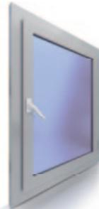
Nach innen schwenkende Fenster können mit Beschlagteilen ausgestattet werden, um einen Lüftungsspalt zu erstellen. Der Mikrolüftungsspalt wird erstellt, indem man den Griff in die Kippstellung bringt, das Fenster leicht öffnet (+/- 5 mm) und dann den Griff um 45° nach unten dreht. Das Fenster ist in einer festen Position mit einem kleinen Spalt von +/- 5 mm verriegelt.
