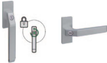
Durch Drehen des Griffs um 90°, wird er in Öffnungsposition gebracht. Wenn der Griff mit einem Zylinderschloss ausgestattet ist, sollte man sich versichern, dass der Zylinder vor dem Drehen des Griffs entriegelt wird.
