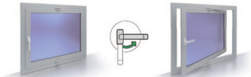
Mit dem Griff kann der Flügel um 90° um die vertikale Drehachse gedreht werden.
