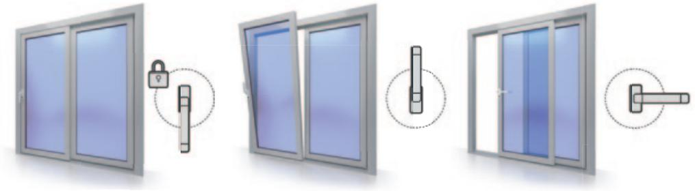
Alle Funktionen werden durch den Griff gesteuert: er entriegelt den Zentralverschluss und schiebt den Flügel weg; entriegelt die Kippstellung; ermöglicht das Bewegen und Einschieben des Flügels; drückt den Flügel an und verriegelt ihn gleichzeitig.
