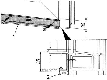
Rysunek 13: Prowadnica ramowa dolna - rysunek montażowy
