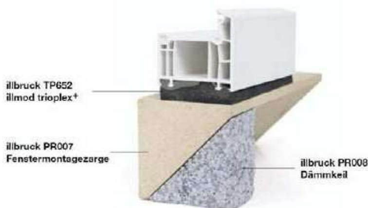
Fig. 11a. Montage de la fenêtre dans la couche d'isolation.
