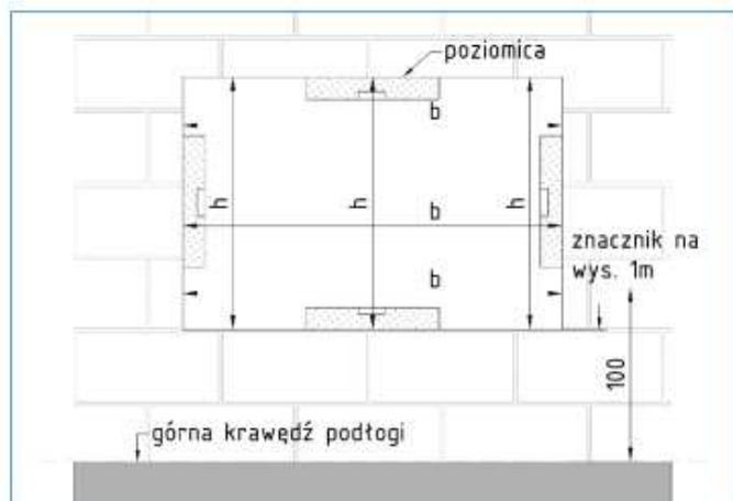
**Fig. 2 méthode de mesure de l'ouverture de la fenêtre**
