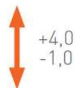
Fig. 90 Réglage de la charnière en hauteur.
