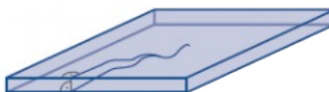
h) Pęknięcie termiczne
