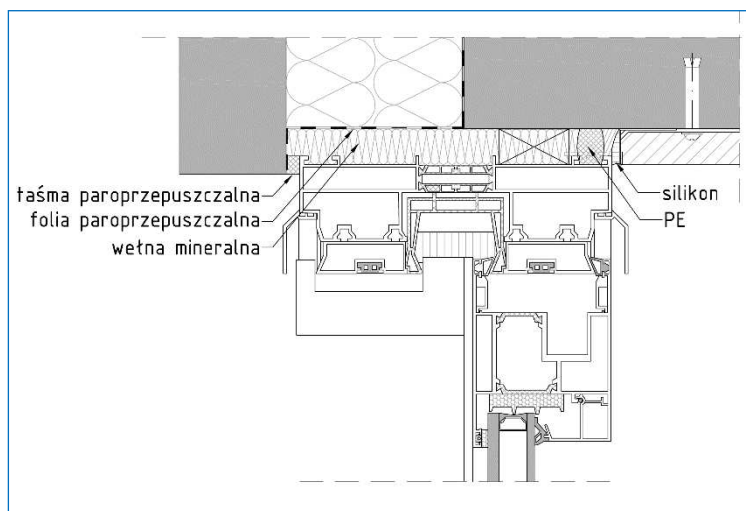
Rys. 33. Przekrój przez nadproże
