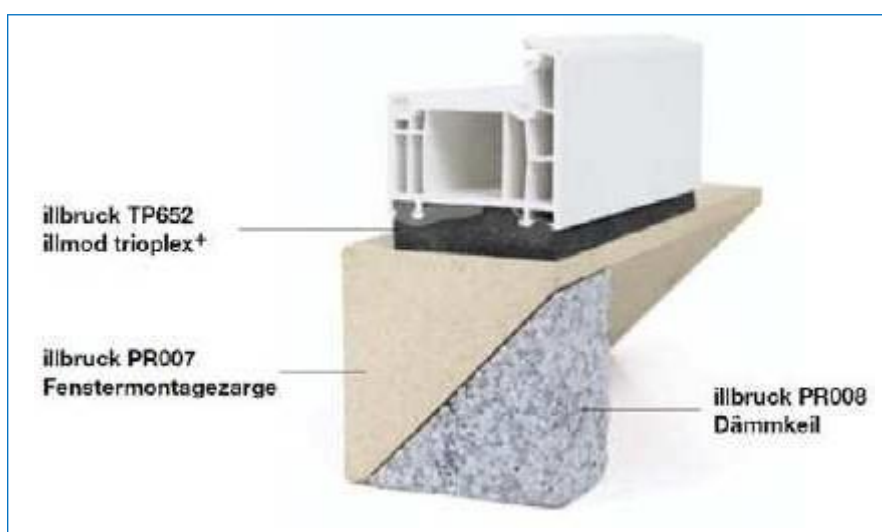
Rys.11a. Montaż okna w warstwie ocieplenia
