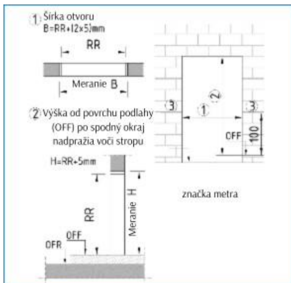
Obr. 3 Spôsob merania okenného otvoru
